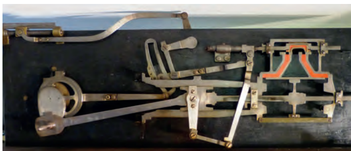
Gibljiv ploskovni, »2D« model parnega stroja na lokomotivi
