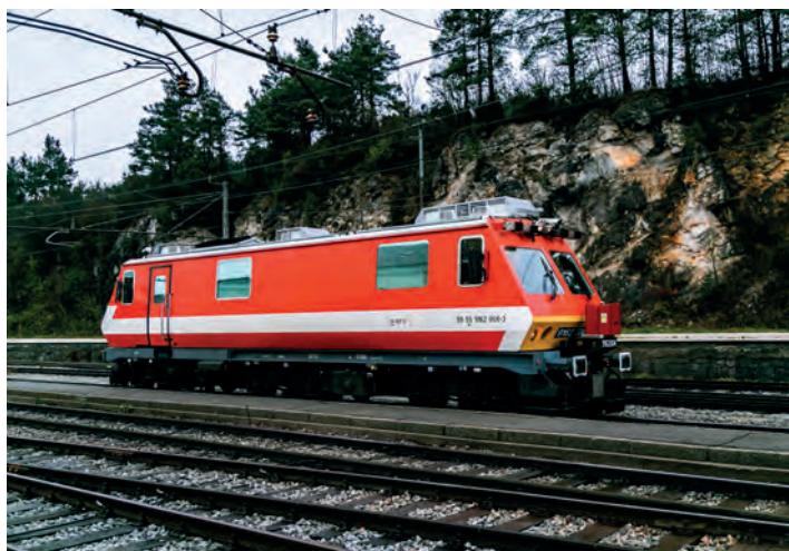
FMK 004 je merilno in inšpekcijsko vozilo, zasnovano za mednarodno uporabo na normalni tirni širini.
