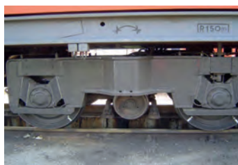
Mehansko merilno kolo merilne drezine FMK 004.
