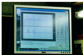
Podatki o parametrih geometrije proge so zagotovljeni za vsakih 25 centimetrov proge
