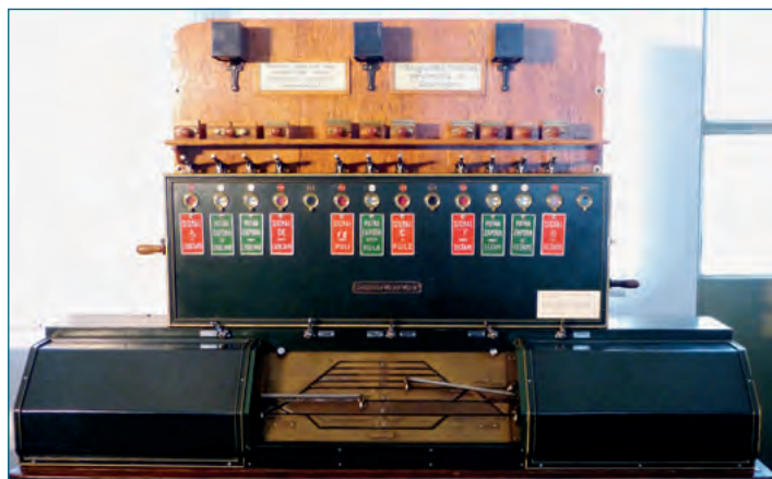
Verižni aparat SBW je bil mehanično preveč občutljiv, da bi se lahko uveljavil. Bila je izdelana le ničelna serija – sedem ali osem aparatov. Ohranili so se trije – enega hranijo v Tehniškem muzeju na Dunaju, drugega v prometnem muzeju v Budimpešti, tretjega, s postaje Divača, največjega in popolnega, pa imamo pri nas.
