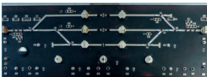
Postavljalna naprava Kilovče je edina tega tipa, ki je ohranjena. V muzeju smo jo pridobili, ko so tam ukinili postajo in Kilovče spremenili v postajališče. Naprava deluje zadovoljivo, slabost pa je, da je njena izdelava v primerjavi z mozaikom draga in da jo je treba popolnoma predelati, če se na primer vgradi nova kretnica.
