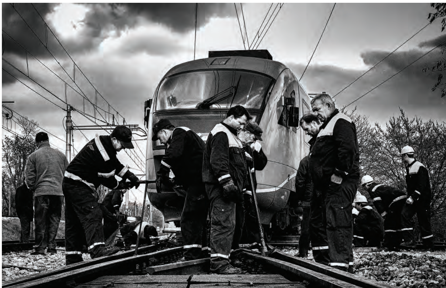
Fotografija Siemensovega Desiroja, ki se je aprila 2004 iztiril na ljubljanski severni postaji. Intervencijska skupina je začela utirjati elektromotorno garnituro, medtem ko drugi delavci načrtujejo, kako bodo sanirali poškodovano krenico.
