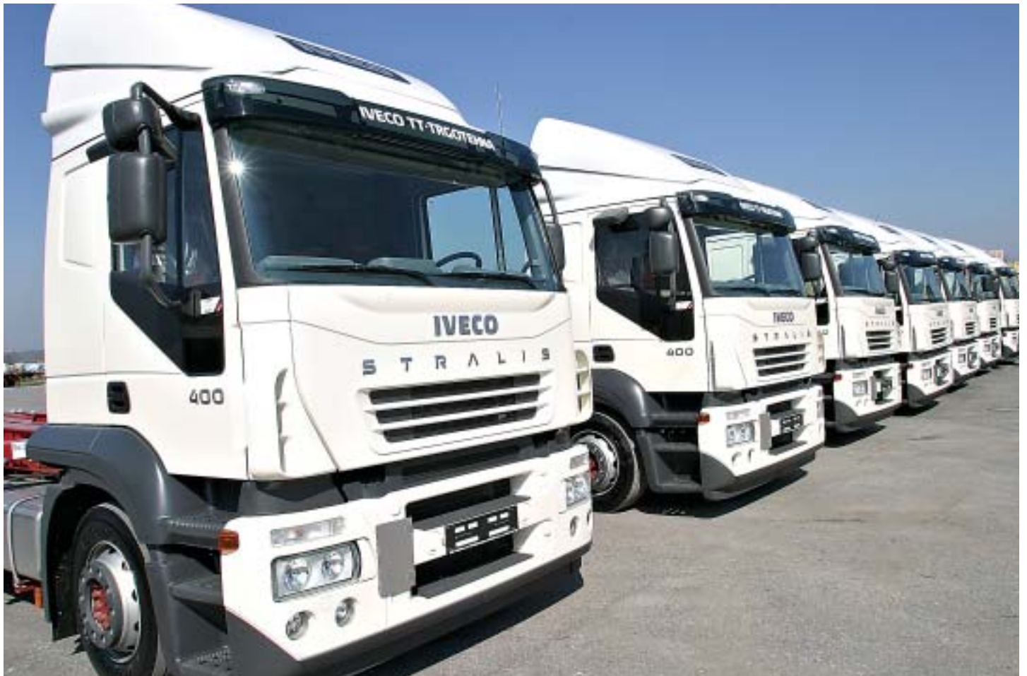
Sodobni vlačilci Iveco s polprikolicami omogočajo prevoze tako imenovanih high cube kontejnerjev in nevarnih snovi.
