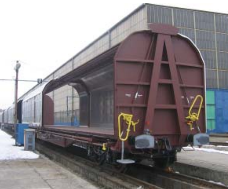
Vsaka bočna pomična stranica se lahko odpre tako, da je naenkrat odprta polovica dolžine vagona.
