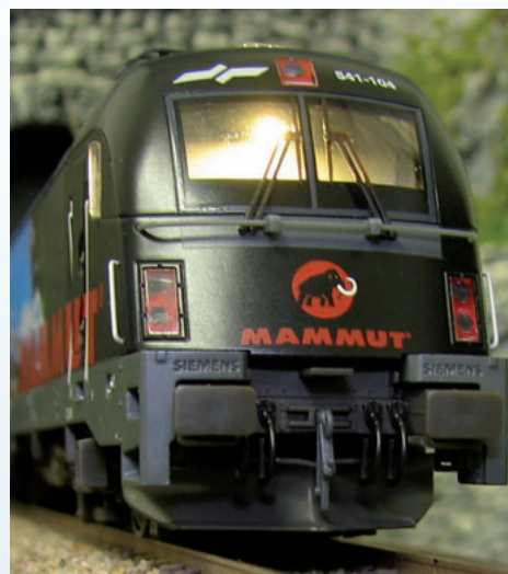
Na prvi strani (kabina 1) je model lokomotive SŽ 541-104 MAMMUT opremljen z dodatki (zračne cevi in vlečni kavelj), kot na pravi lokomotivi.
