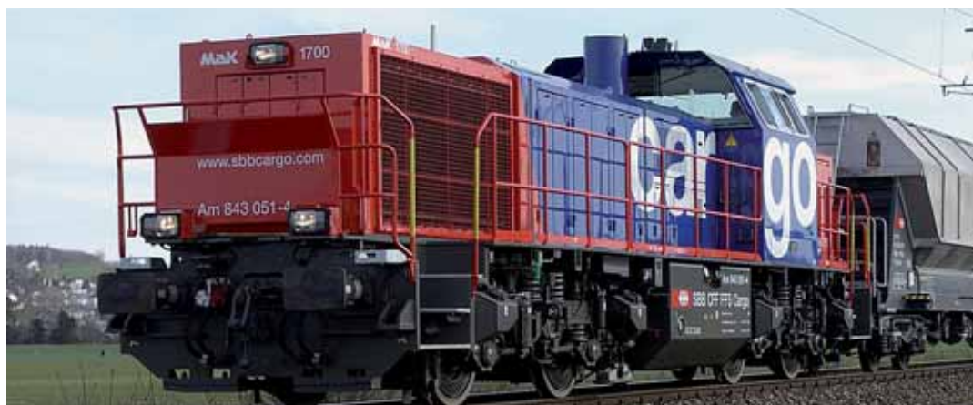
Dizel hidravlična lokomotiva Vossloh G 1700 BB operaterja SBB Cargo (SBB Ae 843) na vleki tovarne kompozicije vagonov.
