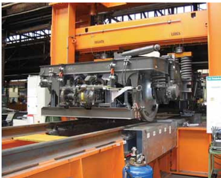
Preizkus podstavnega vozička pod obremenitvijo v Linzu.
