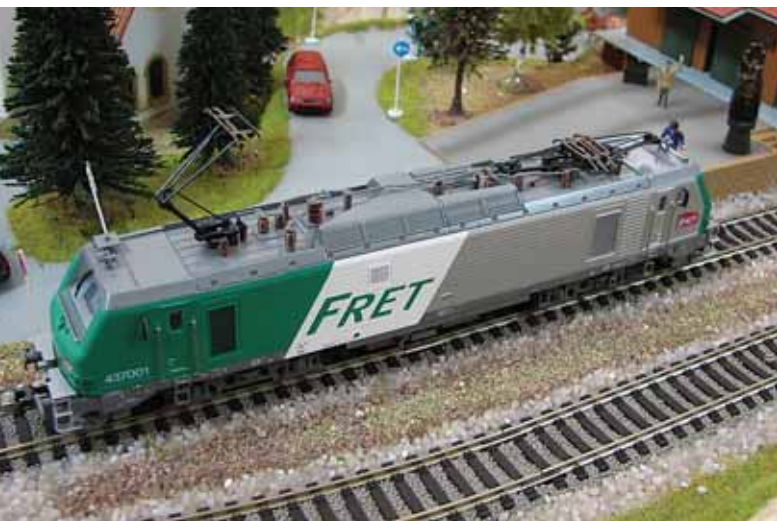
Kovinski tokovni odjemnik je lahko v spuščnem ali dvignjenem (delovnem) položaju. Z njim lahko iz gornjega električnega voda napajamo model z elektriko.
