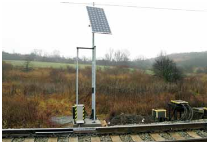
CL-E1 mazalna naprava na Slovaškem z vidim panelom s sončnimi celicami za napajanje.
