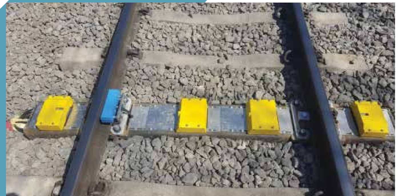
Slika 1 - Detektor vročih osi in pritrjenih zavor (DVO)
