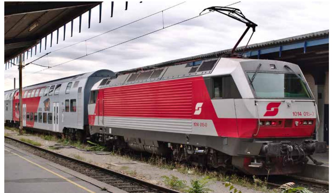
Dvofrekvenčna lokomotiva 1014 za 15 kV 16 2/3 Hz in 25 kV 50 Hz za vožnjo na Madžarsko
