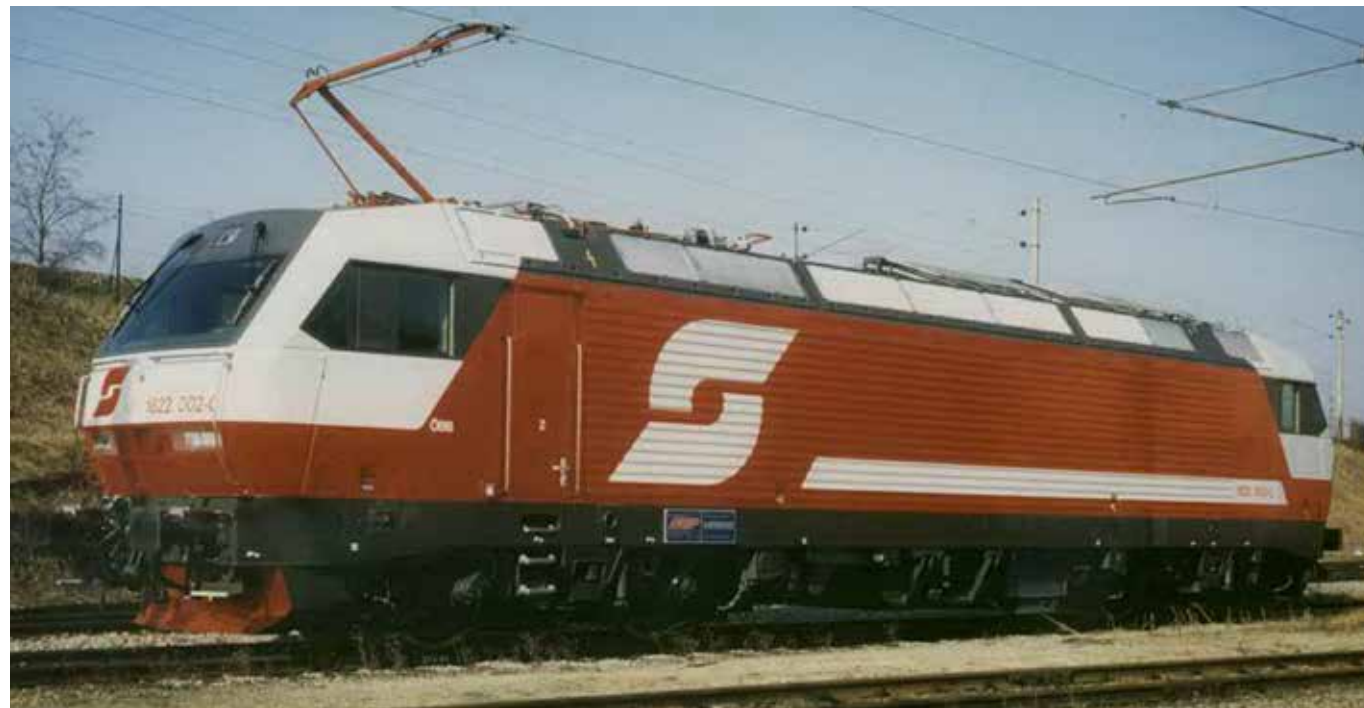
Lokomotiva 1822 za progo čez Brenner za srednjeevropski (15 kV 16 2/3 Hz) in italijanski sistem 3000 V=
