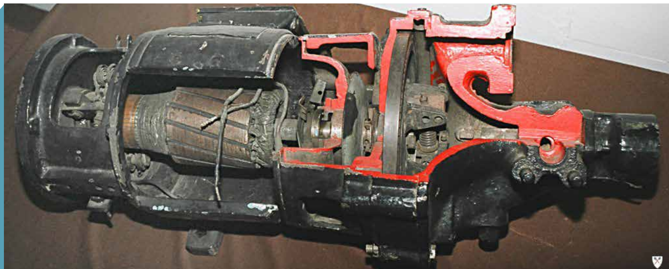
Turbogenerator AEG za parne lokomotive – odlično deluje, je pa kompliciran, drag in občutljiv. Na desni je videti parno turbino, v sredini rotor in na njegovi levi kolektor.
