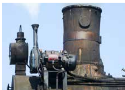
Turbogenerator Stone, nameščen na parni lokomotivi. Človek se ne more načuditi, kako je preprost – na srednji sliki se vidi, da vsebuje le polove čevlje in v njih vtisnjeno električno navitje – iz vsega nekaj ovojev. Rotor-kotva bi tudi ne mogel biti enostavnejši.
