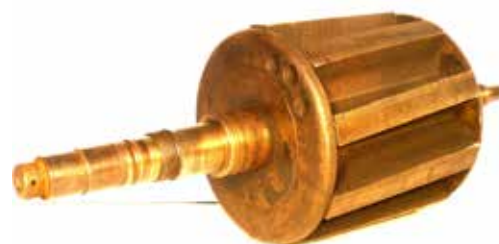
Turbogenerator Stone, nameščen na parni lokomotivi. Človek se ne more načuditi, kako je preprost – na srednji sliki se vidi, da vsebuje le polove čevlje in v njih vtisnjeno električno navitje – iz vsega nekaj ovojev. Rotor-kotva bi tudi ne mogel biti enostavnejši.
