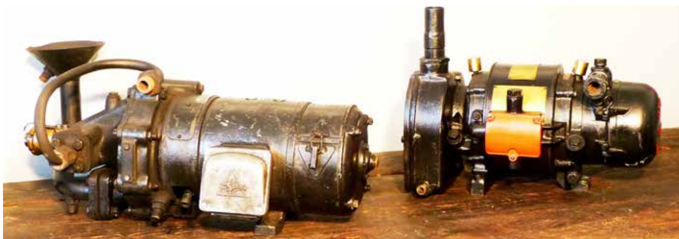
Turbogenerator AEG na levi je licenčno izdelovala tudi naša industrija – turbinski del Jugoturbina v Karlovcu, električni del pa Sever v Subotici. Na desni je Stone enake moči.
