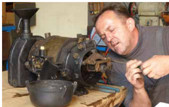
Janez Kermavner s svojo magnetilno tuljavo in Miran Vrbinc, ki si daje opravka z regulatorjem obratov, potem ko je celotni turbogenerator obnovil in spet sestavil.
