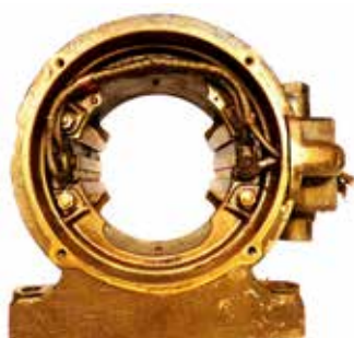
Turbogenerator Stone, nameščen na parni lokomotivi. Človek se ne more načuditi, kako je preprost – na srednji sliki se vidi, da vsebuje le polove čevlje in v njih vtisnjeno električno navitje – iz vsega nekaj ovojev. Rotor-kotva bi tudi ne mogel biti enostavnejši.
