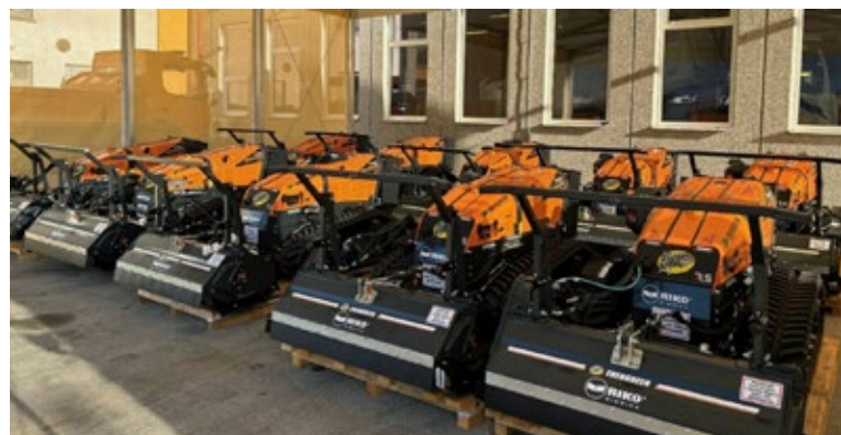
Sodobni samohodni mulčerji z daljinskim upravljanjem za košnjo in čiščenje rastja ob progah (dobavljeni aprila 2024). Vir: arhiv SŽ - Infrastruktura
