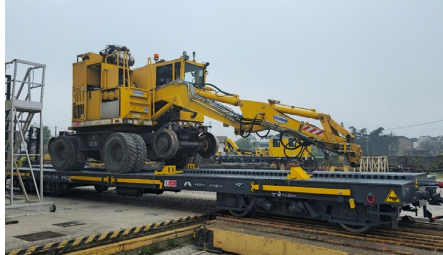
Nizkopodna prikolica za varen prevoz težke železniške mehanizacije med delovišči (predvidena dobava: december 2025).
