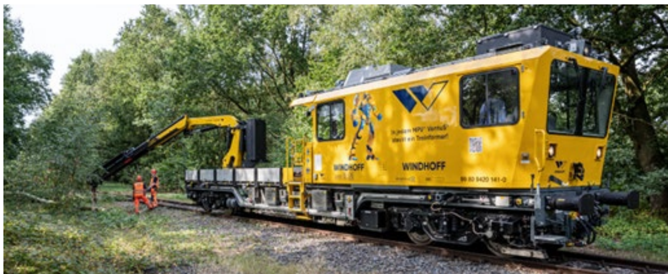
Motorno progovno vozilo za posebne namene za potrebe vzdrževanja železniških tirov. Vir: https://www.windhoff.de/_Resources/Persistent/f/a/7/e/fa7e8448aff381f5895c16efdc9a6b81f576094e/Multibutton_DB%20GAF-1440x961.jpg
