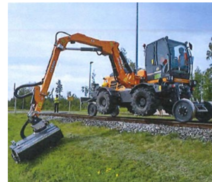
Dvopotno vozilo za košnjo, namenjeno vzdrževanju rastlinja ob železniških progah (predvidena dobava: oktober 2026).
