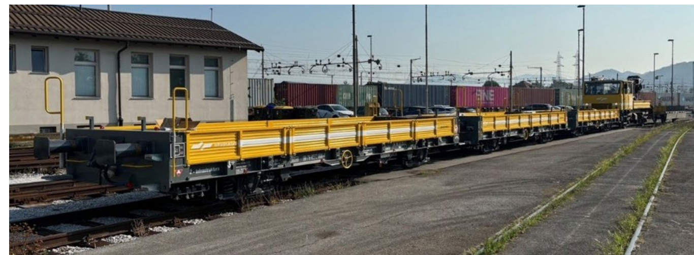
Prevzeti priključni vagoni, pripravljeni za uporabo na železniški infrastrukturi (dobavljeni januarja 2025). Vir: arhiv SŽ - Infrastruktura
