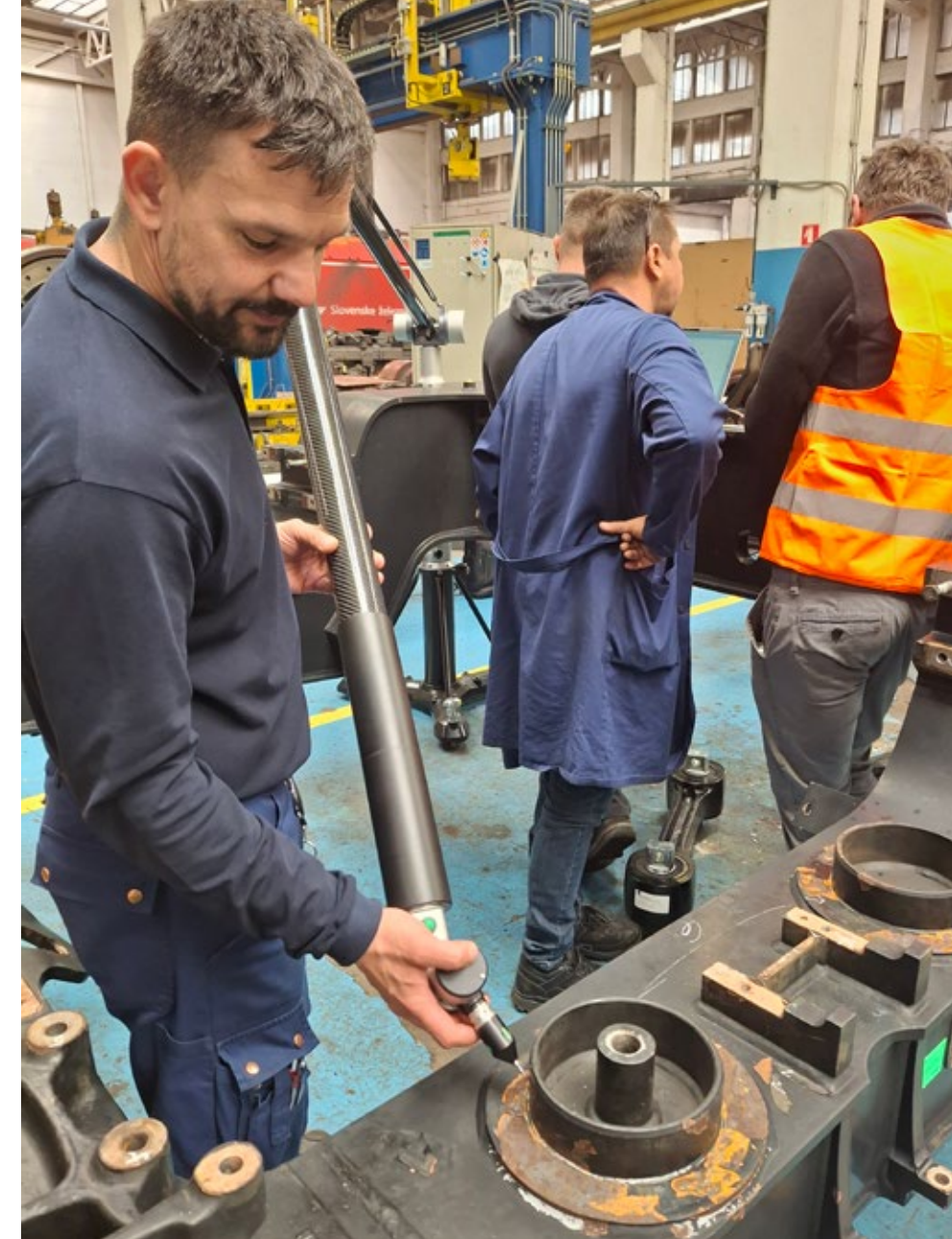
Rok Klenovšek meri osnovni voziček z merilno roko A5
